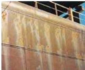
**Corrosiones prematuras debidas a la presencia de calamina**
