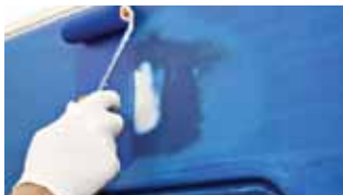
Aplicación de la imprimación sobre la zona reparada.
