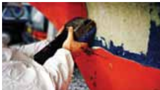
Pelando el gelcoat con una peladora (gelcoat peeler)
