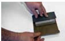
Envolver el bloque con el papel
