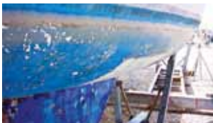
Burbujas y desprendimientos
